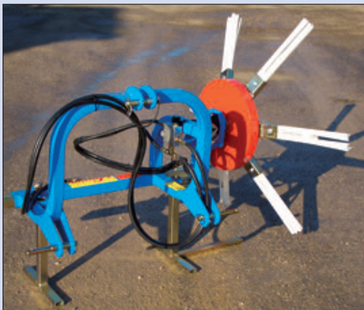
Andanatore laterale applicato posteriormente al trattore Aside Inter Row Rake Tractor's Rear Mounted
